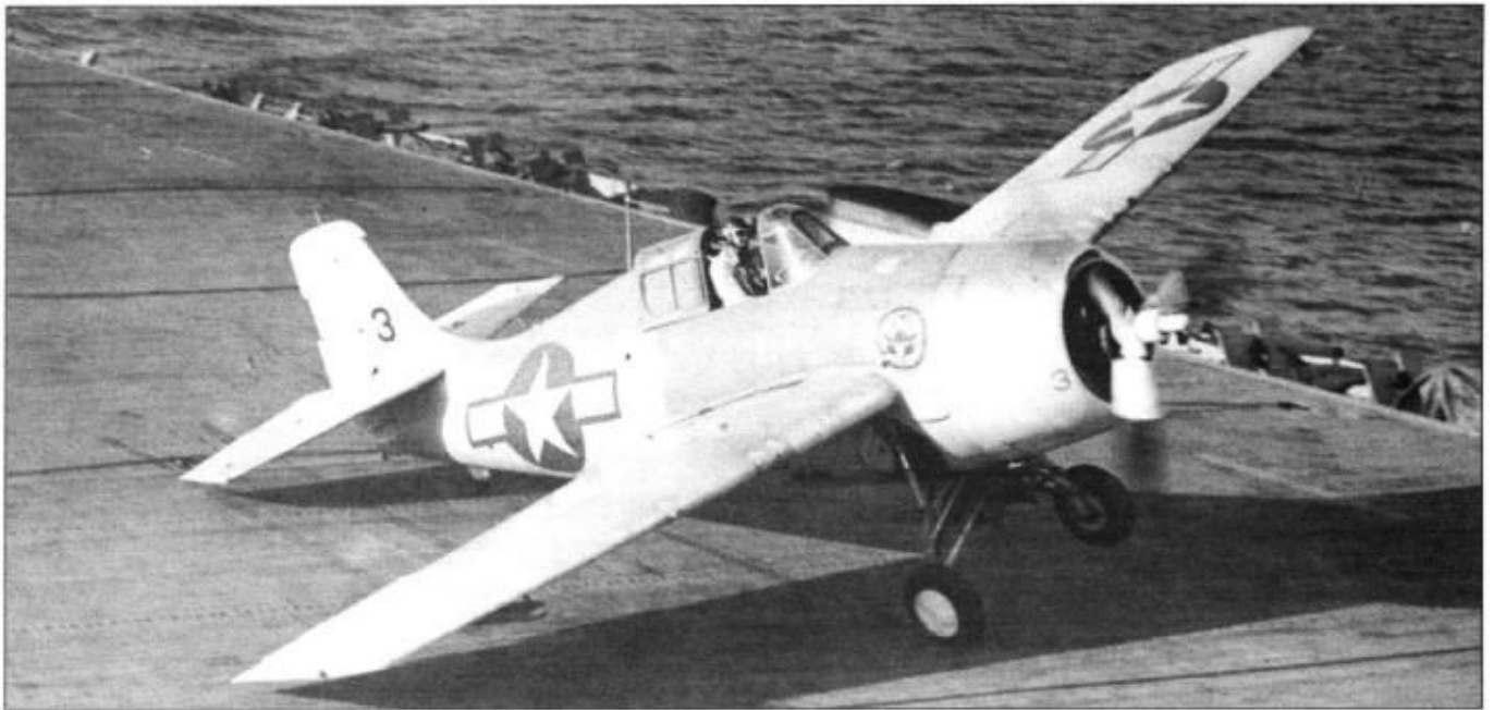
Летчик FM-1 из эскадрильи VC-12 не справился с управлением при посадке на авианосец «Кори», повреждение законцовки правой плоскости крыла неизбежно. Узкая база шасси «Уайлдкэттов» делала посадку трудным делом даже для опытных пилотов. На борту фюзеляжа видна эмблема эскадрильи - кот, нарисованный черной и белой красками.
