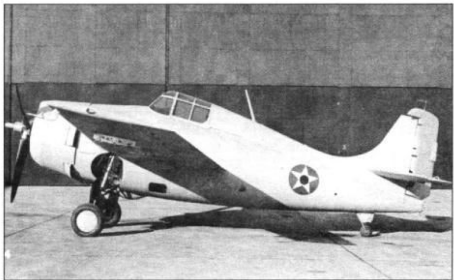
Второй серийный истребитель F4F-4 (BuNo 4059) на заводском аэродроме в Беттсфидже. От предыдущей модификации F4F-4 отличали складывающиеся плоскости крыла, шесть крыльевых пулеметов, модернизированный капот двигателя и ПВД нового типа.
