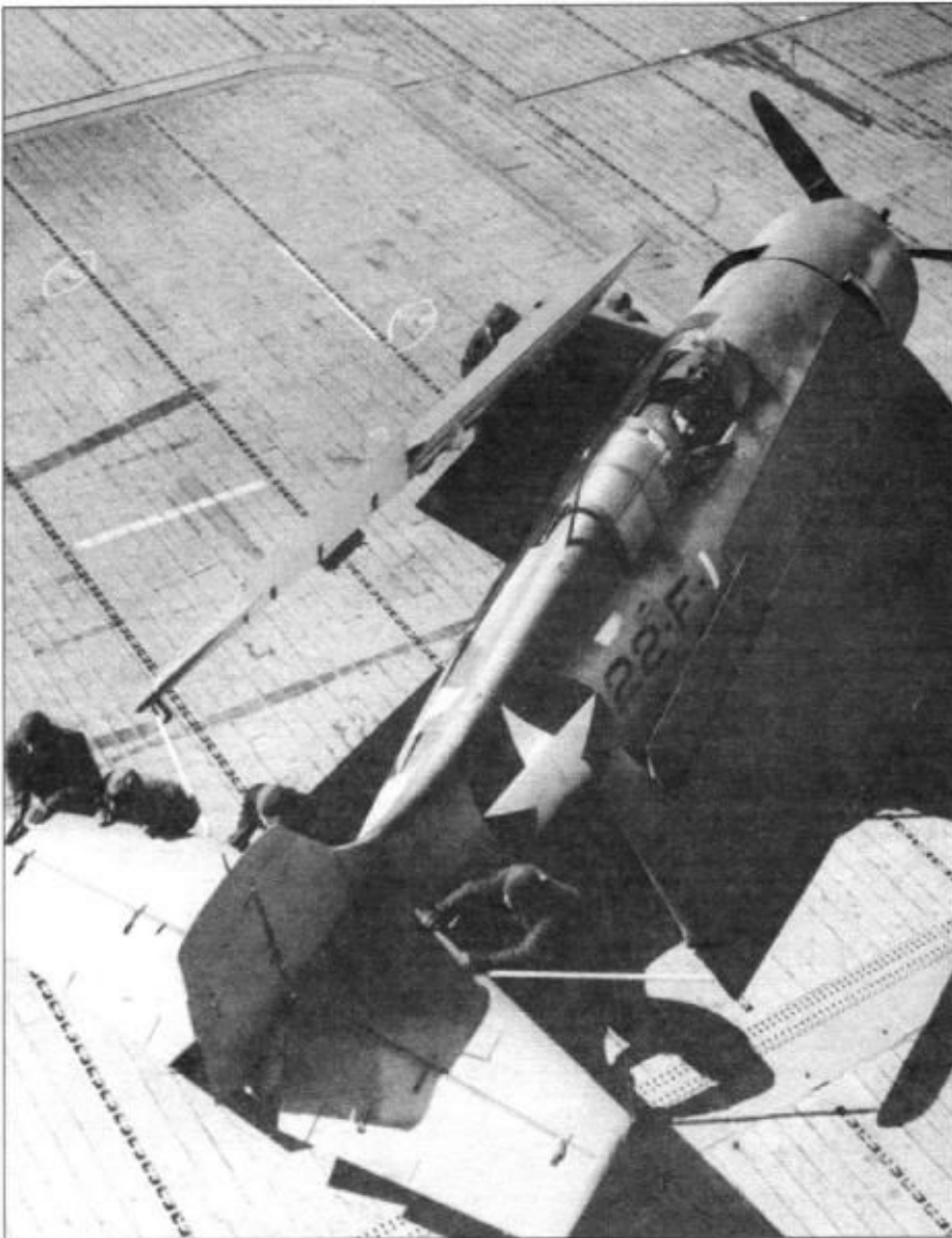
F4F-4 закатывают на самолетоподъемник авианосца «Индепенденс», 30 апреля 1943 г. Самолет окрашен по трехцветной схеме: верх Semi-Gloss sea Blue, низ - Non-specular White, между ними - Non-specular Intermediate Blue. Обратите внимание на стержни между сложными плоскостями крыла и стабилизатором.
