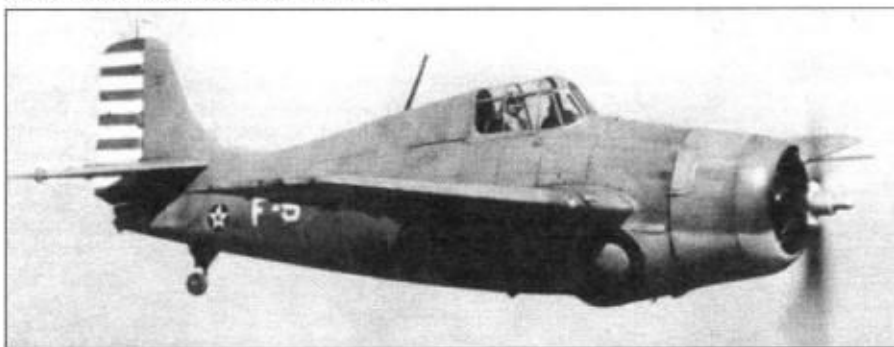
Данный F4F-3 имеет необычную смешанную маркировку. Руль направления окрашен полосами красного и белого цветов, введенными 5 января 1942 г., однако литеры бортового кода белого цвета, хотя при окраске самолета по серо-голубой/светло-серой схеме они должны быть матовыми черными. Серая окраска была введена в октябре 1941 г.
