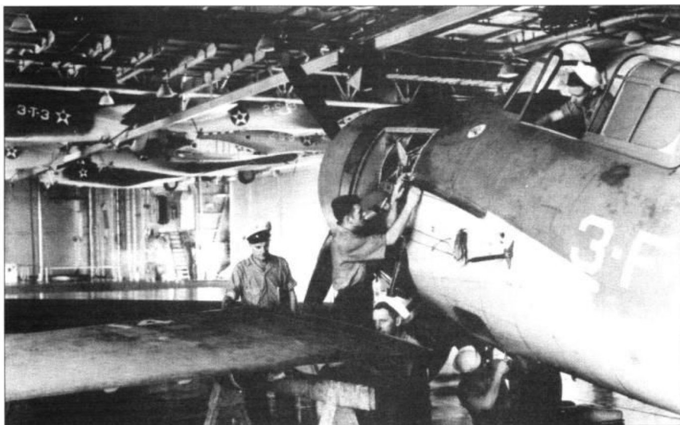
Техническое обслуживание F4F-3 позднего выпуска из эскадрильи VF-3, ангарная палуба авианосца «Энтерпрайз». Обратите внимание на подвешенные запасные воздушные винты разных типов.
