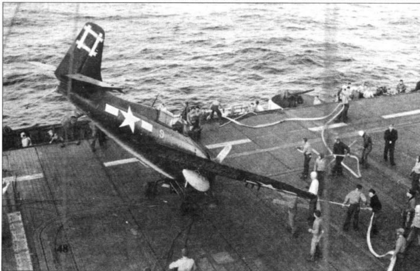
FM-2 из эскадрильи VC-96 встал на нос после неудачной посадки на авианосец «Рэдирд Бэй», 1 апреля 1945 г. Машина вернулась из боевого вылета на Окинаву. Подвесные топливные баки окрашены в белый цвет.
