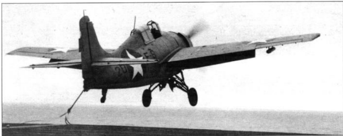
Истребитель F4F-4 из эскадрильи VF-20 взлетает с авианосца «Барнис» (CVE-20), 26 марта 1943 г. Обратите внимание на опущенный гак и падающий трос. Трос удерживает самолет на катапульте пока двигатель не наберет максимальные обороты, с запуском катапульты трос освобождается.
