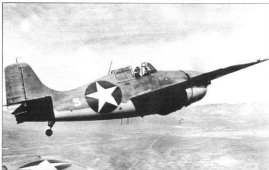
В боевом воздушном патруле истребитель F4F-3 «Уайлдкэт», конец 1942 г. Под фюзеляжем отчетливо видны две штыревых антенны: одна - навигационного радиоприемника ZB-3, вторая - радиоприемника AN/ARR-2.
