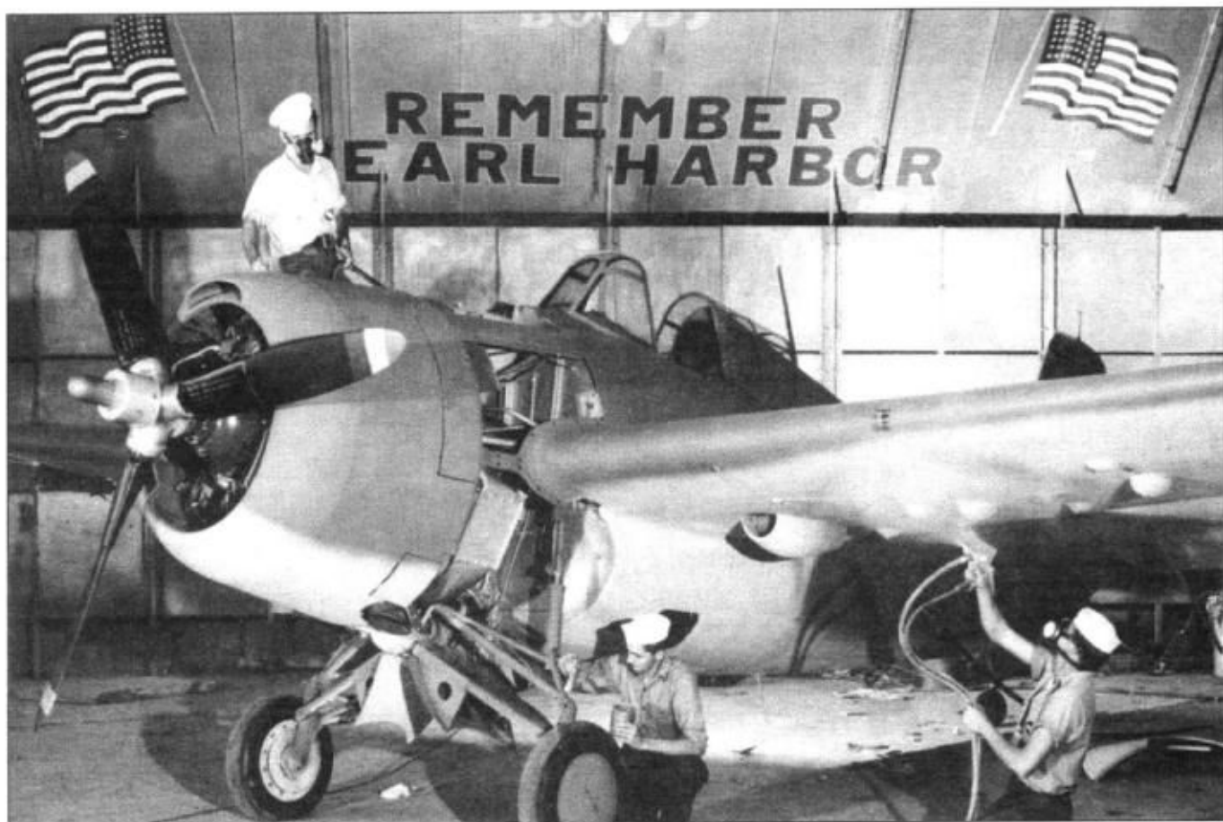
Перекраска самолета F4F-4 в процессе подготовки самолета к участию в разли War Bond, сентябрь 1942 г. Отверстия под крыльевые пулеметы заделаны, прицел демонтирован. Стойки шасси окрашены в зеленый цвет, на стрелевых «Уайлдкэттах» стойки окрашивались в черный цвет.
