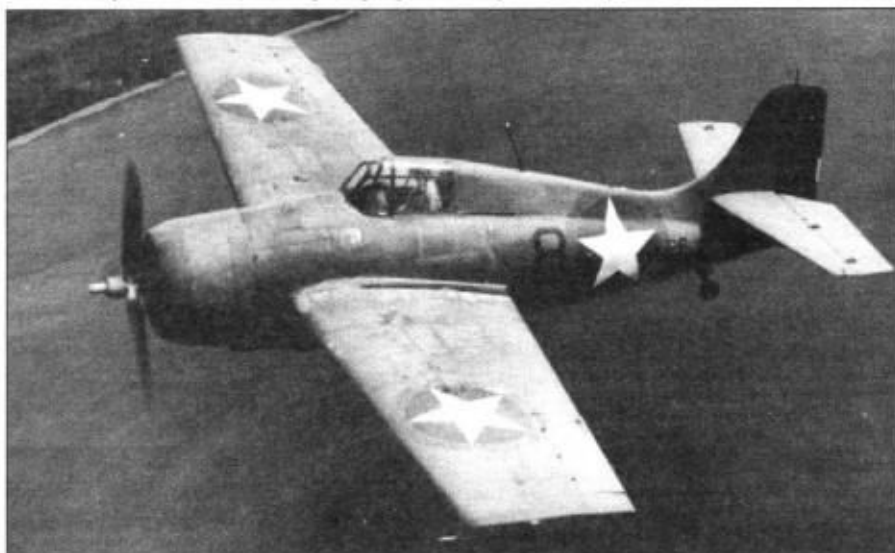
F4F-4 патрулирует воздушное пространство Гудалканала, 6 апреля 1943 г. Обратите внимание на желтую (на снимке средне-серая) кайму вокруг опознавательных знаков. Такая кайма наносилась вокруг опознавательных знаков самолетов, принимавших участие в операции «Торч» - вторжении в Северную Африку. На борту фюзеляжа перед фонарем кабины видна эмблема в виде головы индейца.
