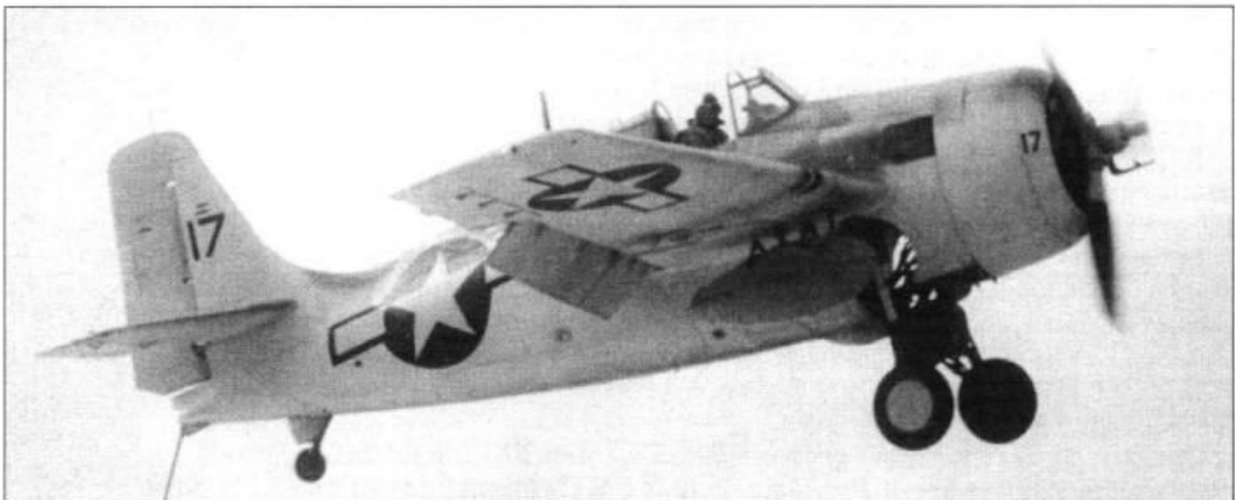
FM-2 из эскадрильи VC-12 садится на палубу авианосца «Коре», 12 апреля 1944 г. Обратите внимание на выпущенные тормозной гак, шасси и отклоненные закрылки. Самолет окрашен по атлантической противолодочной схеме.
