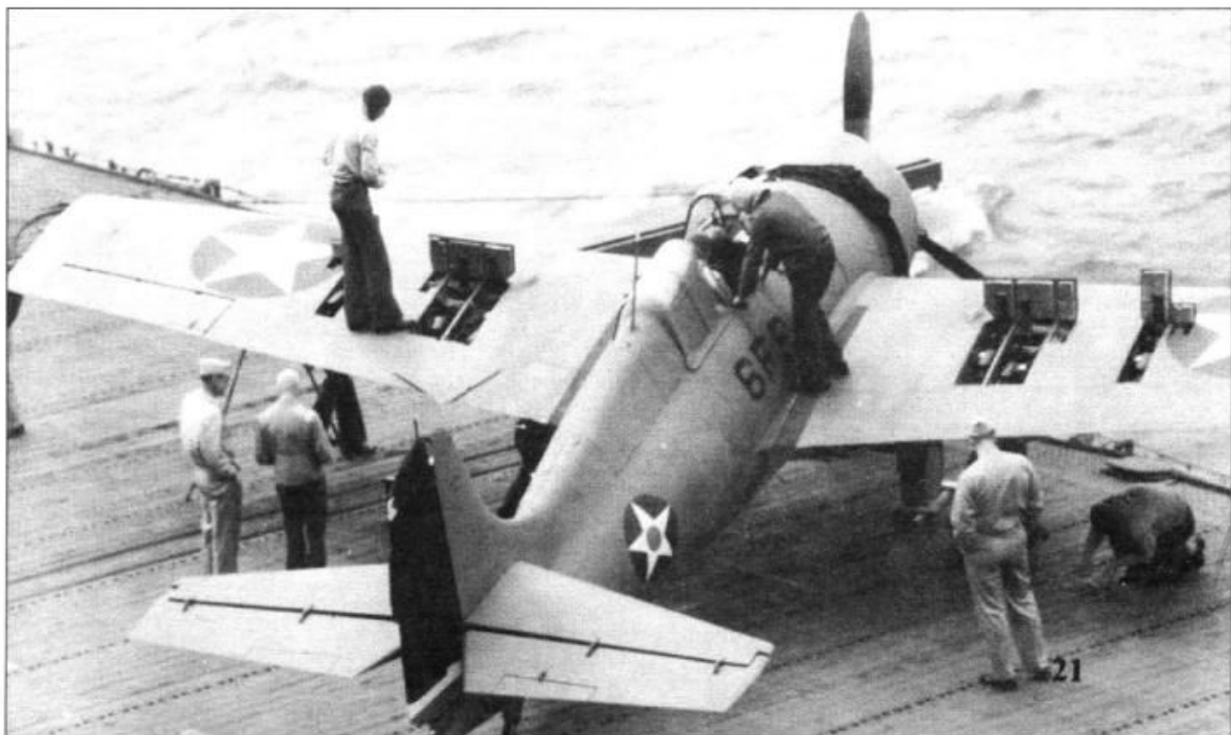
Оружейники поднимают боекомплект и проверяют пулеметы истребителя F4F-4 раннего выпуска из эскадрильи VF-6, авианосец «Энтерпрайз», 10 апреля 1942 г. Обратите внимание - полосатый руль направления закрыт чехлом.
