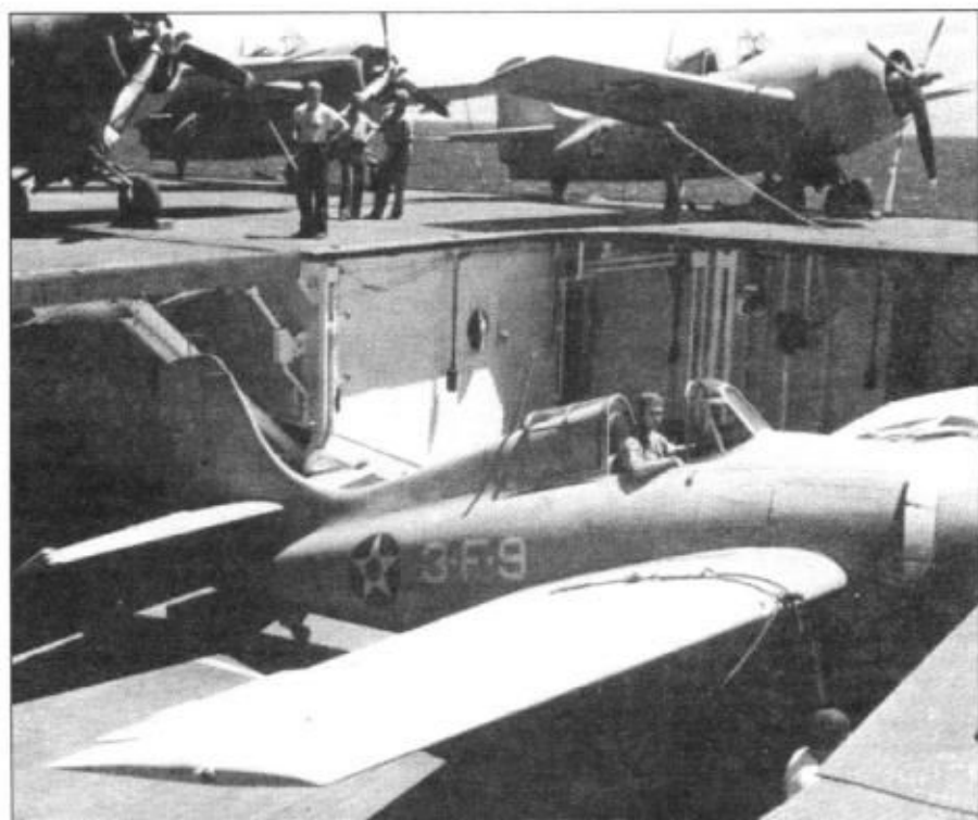
Первый серийный F4F-3A (BuNo 3905) сошел со сборочной линии завода фирмы Грумман 7 апреля 1941 г. На самолеты F4F-3A ставились двигатели Pratt-и-Whitney R-1830-90 мощностью 1200 л.с., в то время как на F4F-3 стояли моторы R-1830-76. Тридцать предназначенных для ВМС США самолетов были переданы согласно заключенному контракту Греции, однако когда Греция капитулировала когда транспорты с самолетами находились еще в море, поэтому они разбурнулись и пошли на Гибралтар.
