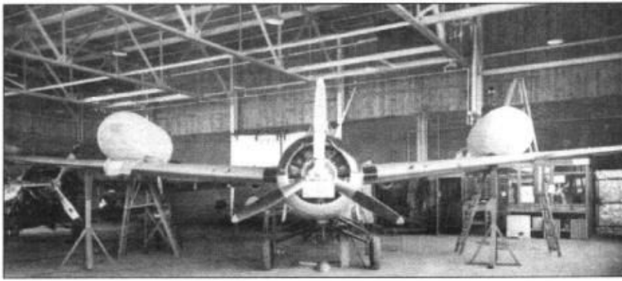
F4F-3 ранней серии во время заводских испытаний аварийных поплавок. Видна разница в расположении поплавков, вызванная переносом пулеметов в крыло. Из-за ложного срабатывания аварийных поплавков в полете погибло двое пилотов, вследствие чего от их использования в будущем отказались.
