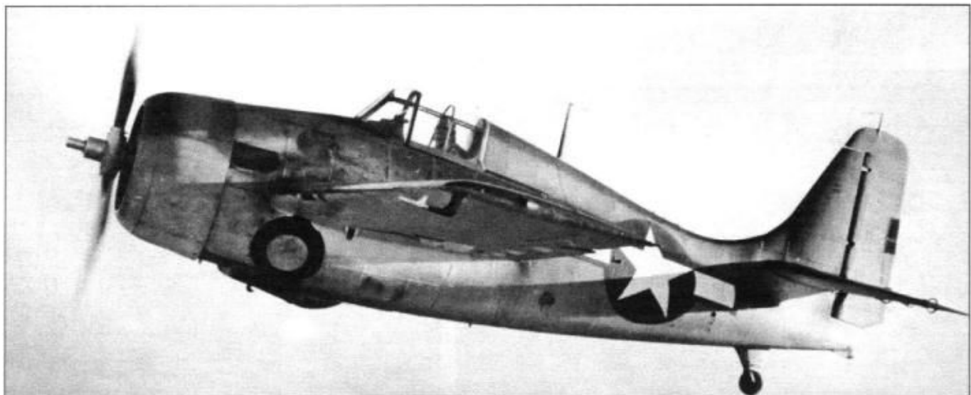
Серийные истребители FM-2 имели вертикальное оперение, аналогичное установленному на втором прототипе XF4F-8. FM-2 стал самым массовым вариантом «Уайлката» - до окончания в 1945 г. серийного производства их выпустили более 4400 экземпляров.
