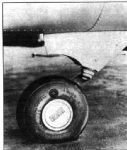
Хвостовое колесо с пневматической шиной, предназначенное для самолетов, действующих с полевых аэродромов.
