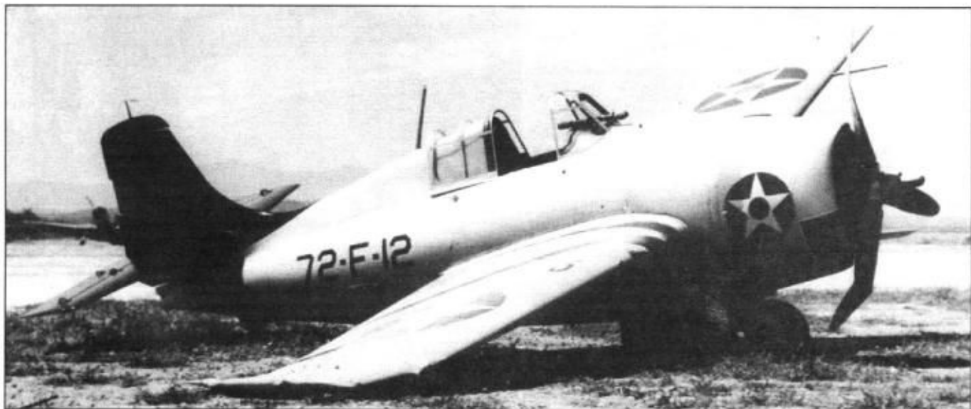
Результат неудачного приземления одного из первых серийных F4F-3 (самолет из эскадрильи VF-72), 25 февраля 1941 г., Гуантанамо-Бэй, Куба. Хвостовое оперение - блестящее черное, идентификационный цвет авианосца «Уосп», шевроны на крыле и полоса на капоте - блестящие черные с белой окантовкой.
