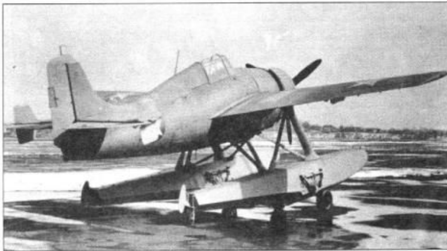
Прототип гидролана F4F-3S «Уайлдкэтфиш», Норфолк, 2 декабря 1942 г. Для облегчения передвижения гидролана по суше на поплавках установлены небольшие колеса. Перед полетом колеса демонтировались. Обратите внимание на вертикальные шайбы на концах горизонтального оперения. Шайбы призваны компенсировать ухудшение устойчивости по курсу, вызванное установкой массивных поплавков.
