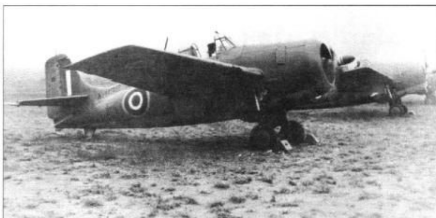
Техники прогревают двигатели самолетов «Мартлет» Mk II на одном из аэродромов в Великобритании. «Мартлет» Mk II F4F-4 со складывающимся крылом и шестью крыльевыми пулеметами. «Мартлеты» из состава Royal Navy окрашивались по следующей схеме: верх - Extra Dark Sea Grey и Slate Gray, низ - Sky type S.
