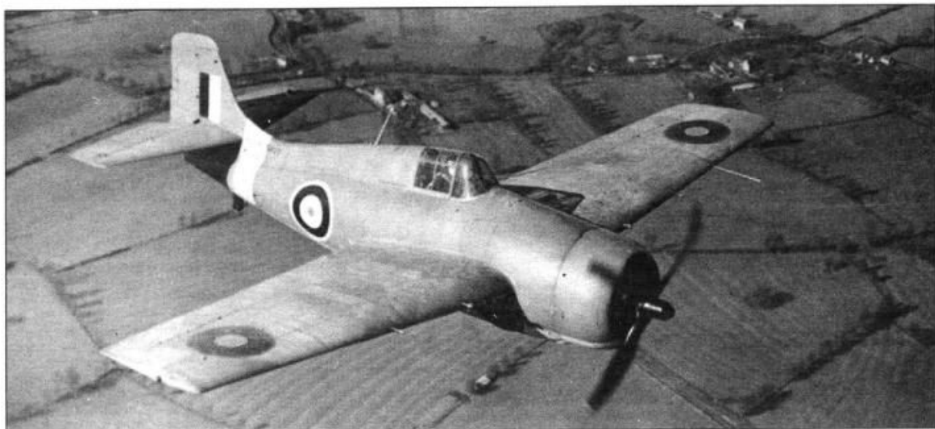
Истребитель «Мартлет» Mk I (бортовой код «AL257») из 759-й или 778-й эскадрилий морской авиации Великобритании в полете, июль 1940 г. Характерным внешним отличительным признаком самолетов «Мартлет» Mk I является наличие кожухов на выступающих из плоскостей частях стволов крыльевых пулеметов.
