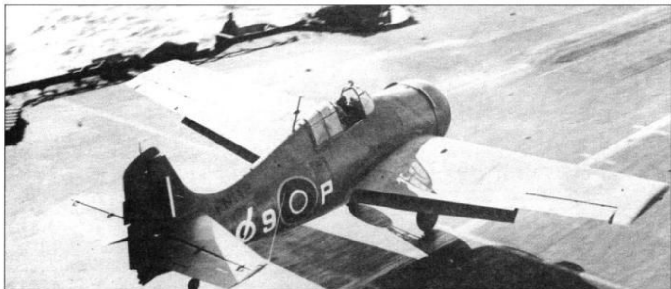
Истребитель «Мартлет» Mk IV (FN142) из 893-й эскадрильи взлетает с палубы авианосца «Формидэбл», Средиземное море. Провод между стабилизатором и фюзеляжем - антенна системы «свой-чужой».
