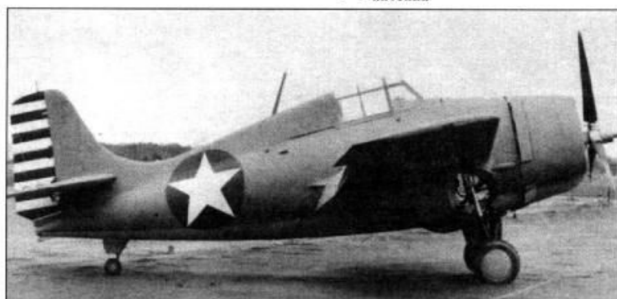
F4F-4 (BuNo 5262) - 233-й построенный самолет данной модели. Эта машина использовалась фирмой Грумман для отработки закрылков. Модернизацию сочли ненужной, на серийные машины такие закрылки внедрять не стали. Необычна комбинация красно-белых полос на руле направления и бело-голубых опознавательных знаков.
