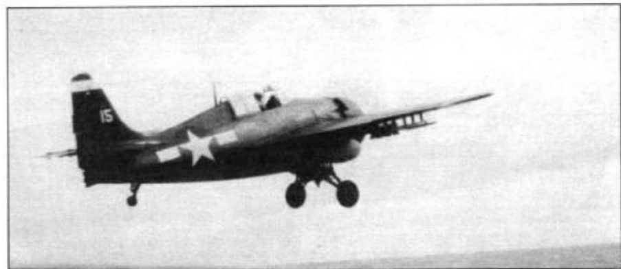
С палубы авианосца «Мэкин Айленд» взлетел FM-2 из эскадрильи VC-8, 29 марта 1945 г. Самолеты FM-2 позднего выпуска оснащались узлами подвески (по пять под каждой плоскостью) для ракет HVAR.
