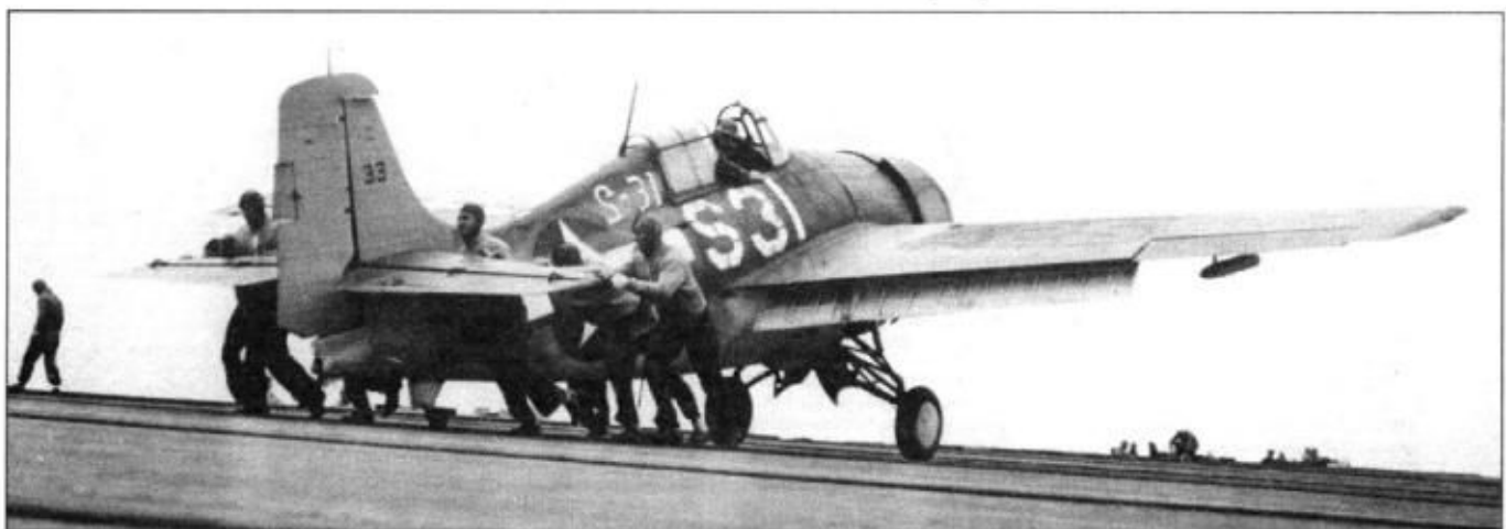
Палубная команда перекатывает FM-1 из эскадрильи VC-33 на новое место, палуба авианосца «Нассау», 6 сентября 1943 г. За исключением вооружения FM-1 ничем не отличался от F4F-4. На верхней поверхности правой плоскости крыла проступает закрашенный прежний бортовой код самолета - «25».
