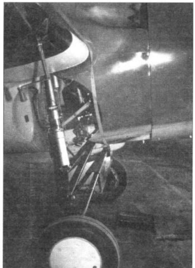
Шасси FM-2/«Wildcat VI». Вверху вставлена ручка для складывания крыльев.
