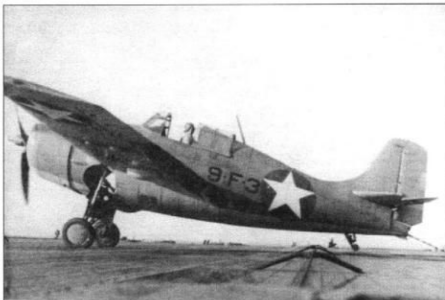
Хвостовой гак зацепил тормозной трос, авианосец «Рэйджер», 22 октября 1942 г. Садится F4F-4 из эскадрильи VF-9. Гак окрашен черно-белыми полосами.
